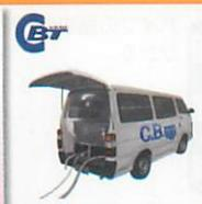
電気集塵機等フィルターの移動洗浄車
