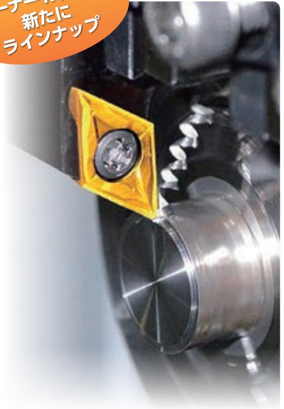
コーナ先端付近まで突出したドット形状。
