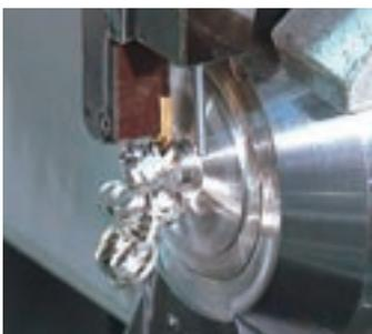
ワーク、工具への切屑絡み
