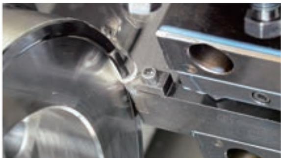
航空機産業で主に使われている耐熱合金は熱伝導率が低く高温強度及び加工硬化が大きい上に、工具材料との親和性(溶着性)が高いため、切削することが非常に困難な「難削材料」とされており、生産効率の向上が課題となっていました。BIDEMICS/バイデミックスは、さまざまな素材を融合させて、高強度・高硬度を実現した新しいカテゴリーの材料です。従来品の超硬合金やセラミックスを上回る高能率加工が可能です。
