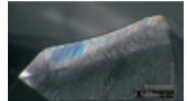
切削条件 工具 Tool : AQDEXR6.0 穴深さ Depth : 21mm
