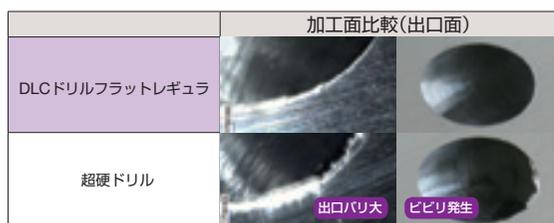
**切削条件 Drilling condition**
