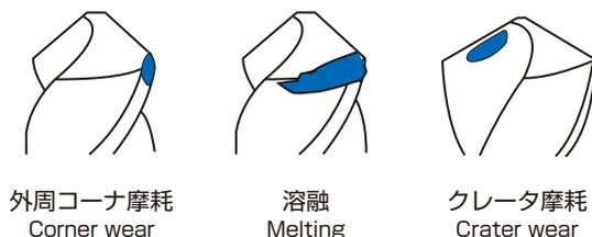
摩耗の進行による切刃の破損
