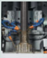
■写真1 photo1 従来加工 Conventional 塩素分を多量に含有する 油性クーラントを大量に使用
