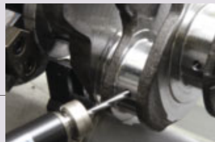
クランクシャフトへの穴あけ加工 MQL machining of a crankshaft
