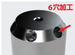
ノズル SUS304 ø5.5 (3D) 穴あけ (後工程でø6.0に仕上げ)
