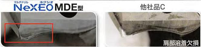
**ステンレス鋼加工** 被削材: インジェクター SUS304 切削条件:  $v_c=60\text{m/min}$   $f=0.1\text{mm/rev}$  内部給油(水溶性)
