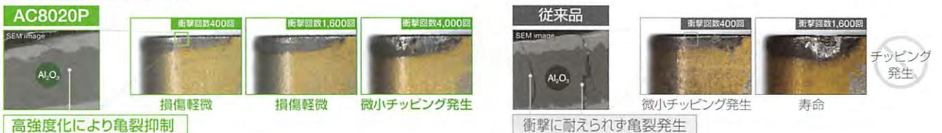
被削材: SCM435 (鍛造材断続部有り) インサート: CNMG120408N-GU (AC8020P) 切削条件:  $v_c=250\text{m/min}$   $f=0.3\text{mm/rev}$   $a_p=1.5\text{mm}$  Wet
