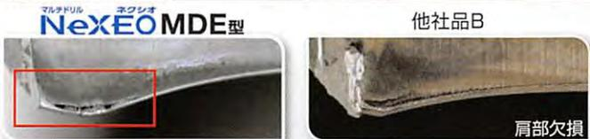
**合金鋼加工** 被削材: シャフト SCM415 切削条件:  $v_c=110\text{m/min}$   $f=0.2\text{mm/rev}$  内部給油(水溶性)
