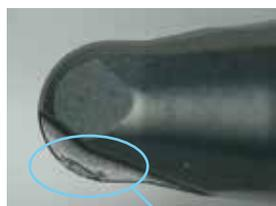
UDCB: 切れ刃のコーティングが損傷し、加工面に段差が発生
