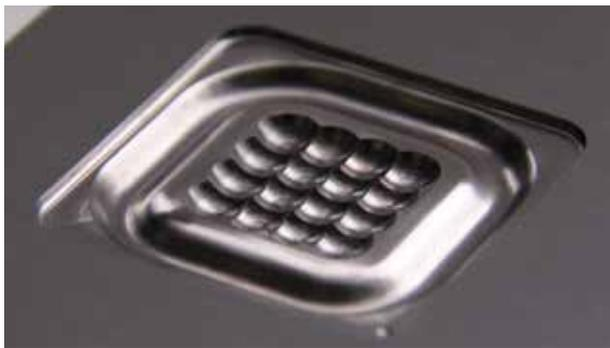
5 軸加工機により曲面を高精度に加工
