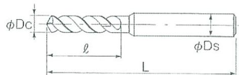
用途: ステンレス、一般鋼、炭素鋼、銅、アルミニウム、Ti合金 Stainless steel, General steel, Carbon steel, Copper, Aluminum, Titanium alloy
