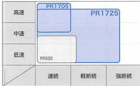
PR1725:鋼加工の第1推奨、PR1705:快削鋼の第1推奨
