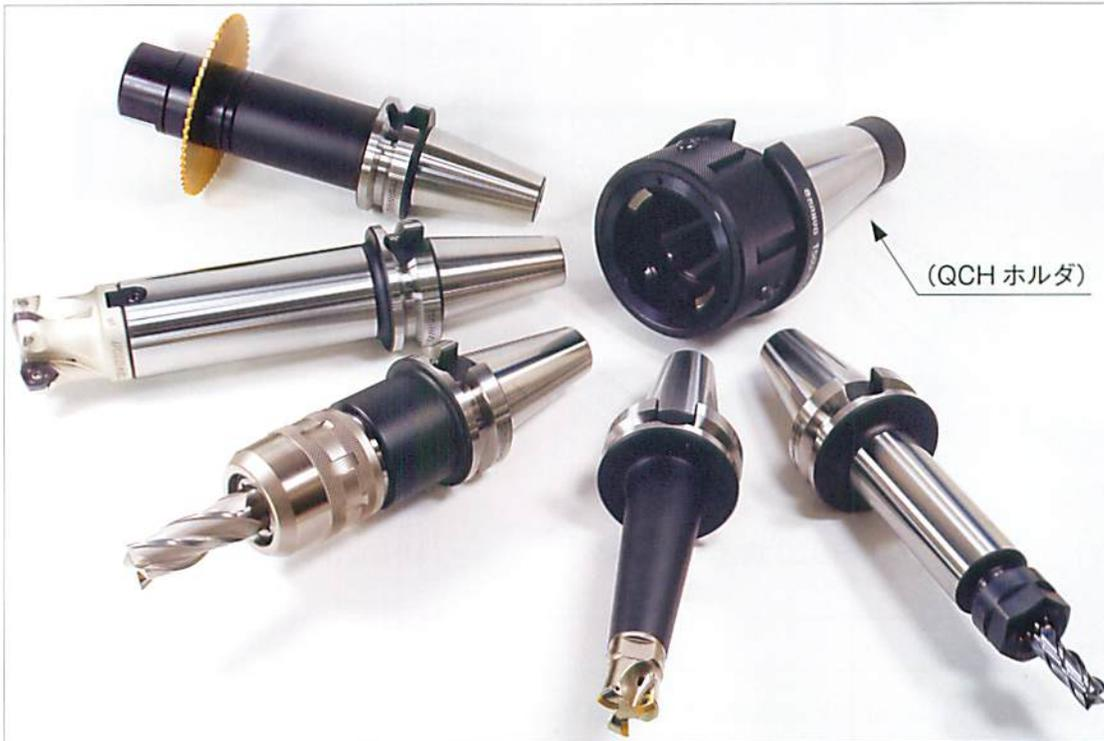
BT シャンクの V フランジを利用したナット締付け脱着システム。
