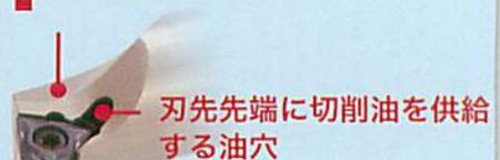
刃先先端に切削油を供給する油穴
