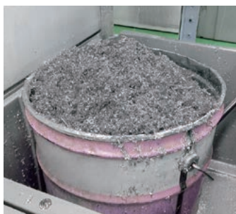
切屑ストッカーのあふれ Overflowing from chips cans
