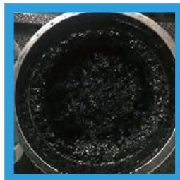
廃油タンク内 オイル沈殿物
