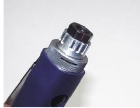
排気方向調整付、空気流量調整付
